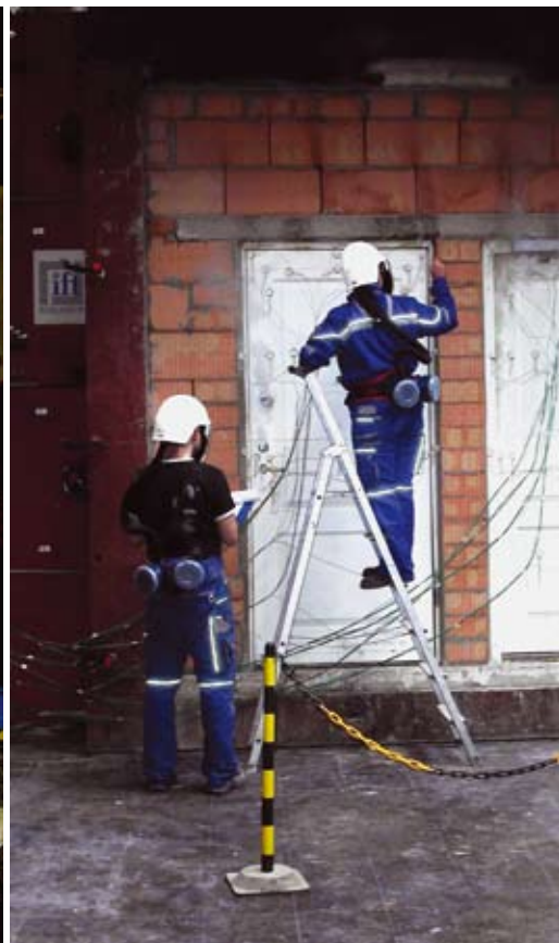
↑ PRIEŠGAISRINIŲ DURŲ BANDYMAI ATLIEKAMI NOTIFIKUOTOJE IFT ROZENHEIMO LABORATORIJOJE
