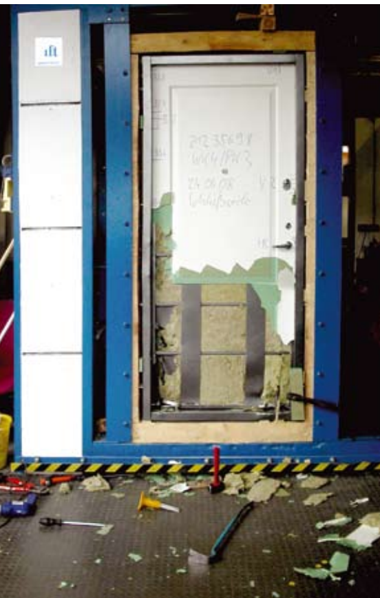
↑ ĮSILAUŽIMO BANDYMAI NOTIFIKUOTOJE IFT ROSENHEIM LABORATORIJOJE. PAGAL ENV 1627 STANDARTĄ BANDOMOS KETVIRTOSIOS SAUGUMO KLASĖS DURYS „SKYDAS PREMIUM“. LAUŽIAMA ĮVAIRIAIS LAUŽTUVAIS, KALIMO, PJOVIMO IR ELEKTRINIAIS GRĘŽIMO ĮRANKIAIS. ŠIOS DURYS BUVO BANDOMOS IŠLAUŽTI NET 77 MINUTES GRYNOJO LAIKO, BET JŲ ATIDARYTI TAIP IR NEPAVYKO
